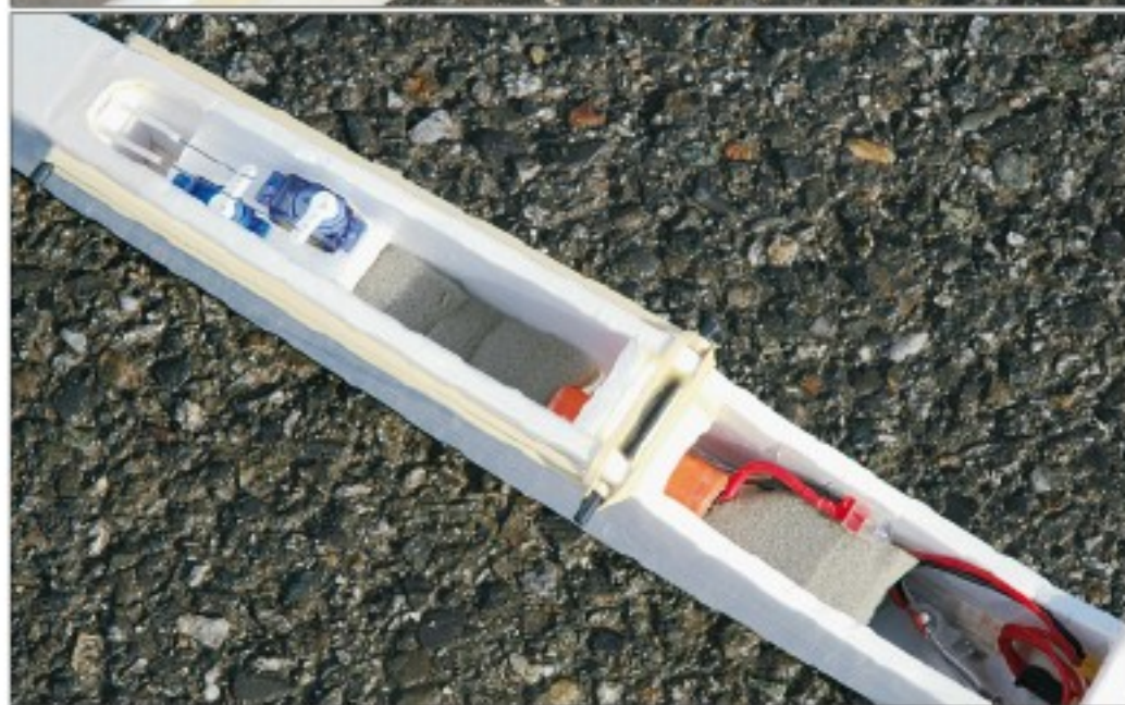
Ces deux photos détaillent l'implantation des équipements, ce demeurant assez simple. À noter le moteur positionné entièrement à l'extérieur pour plus de simplicité.
