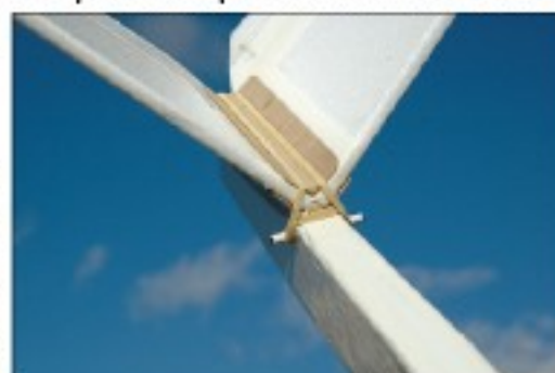
Le système de stabilisateur démontable repose sur un berceau et un taquet de bridage.
