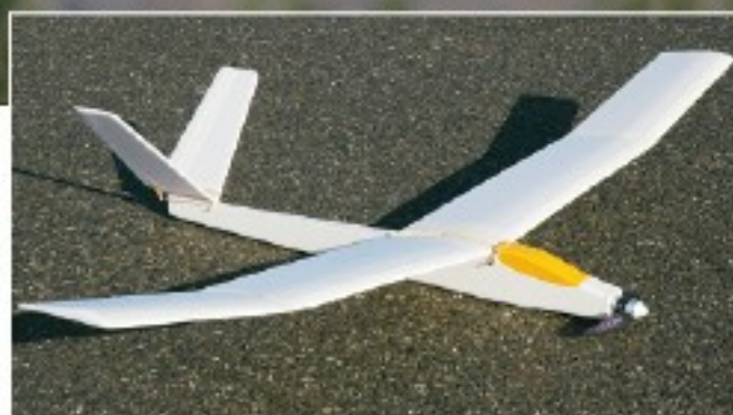
Vu de face, le PolyTwo affiche sans complexe l'originalité de son stabilisateur en V très fermé et une évolution du dièdre des ailes tout aussi harmonieuse (la photo au sol atteste de l'élégance de l'oiseau que soigneusement calculée.
