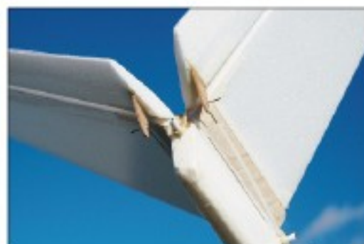
Les commandes de profondeur et direction s'auto maintiennent sur les guignols par effet de ressort vers l'extérieur.
