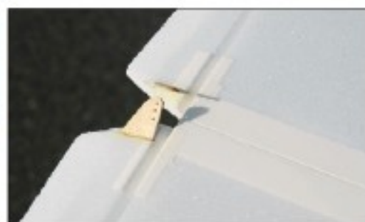
Le stabilisateur démontable est articulé en son centre pour assurer un positionnement parfait une fois monté sur son berceau.
