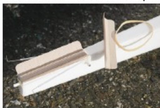
Le système de stabilisateur démontable repose sur un berceau et un taquet de bridage.
