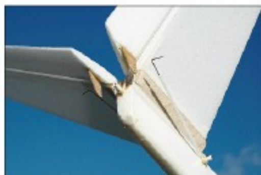
Les commandes de profondeur et direction s'auto maintiennent sur les guignols par effet de ressort vers l'extérieur.
