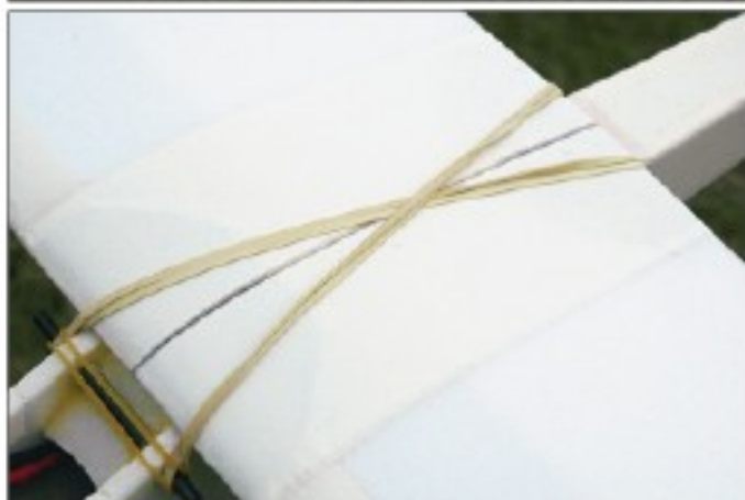
La clé d'ailes inclus le dièdre central. Une fois les ailes raccordées sur leur clé, leur fixation sur le fuselage est confiée à quatre élastiques croisés. Voici d'ailleurs un mauvais exemple, car l'un des élastiques légèrement dégradé est à remplacer d'urgence.
