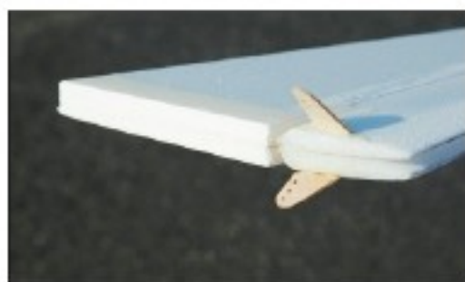
Le stabilisateur démontable est articulé en son centre pour assurer un positionnement parfait une fois monté sur son berceau.
